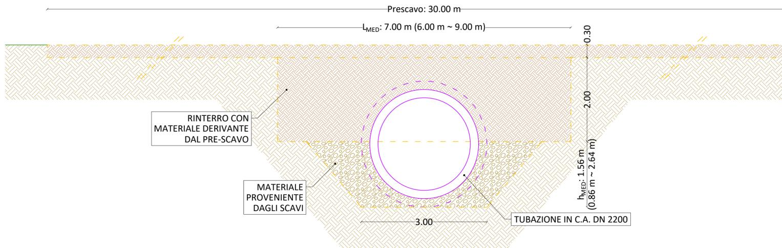
SEZIONE TIPO DI SCAVO SU TERRENO AGRICOLO - DN2000
