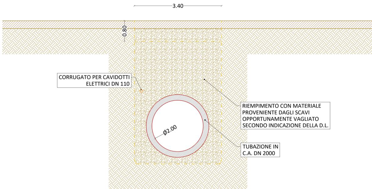
SEZIONE TIPO DI SCAVO SU STRADA BITUMATA
