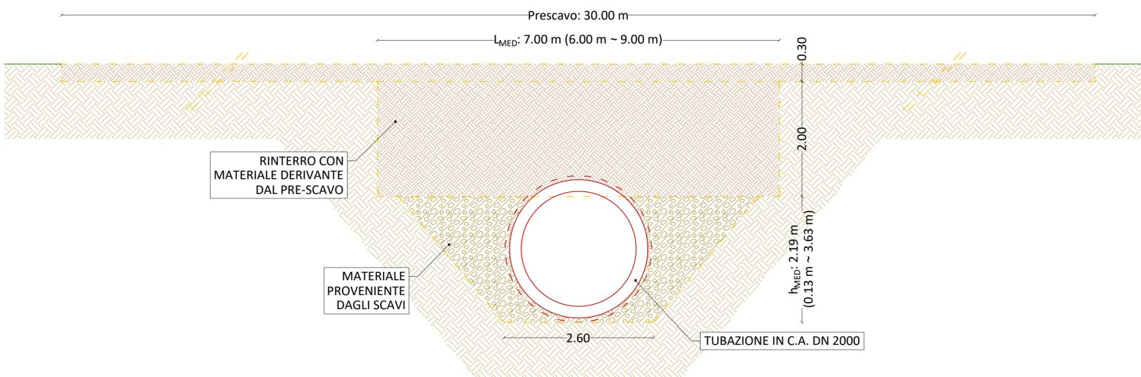
**N.B.:** Il materiale in esubero proveniente dagli scavi verrà in parte utilizzato per il rinterro e locali rimodellamenti morfologici delle aree interessate dai lavori ed in parte sarà frantumato ed utilizzato per ripristinare le strade bianche oggetto di transito dei mezzi di cantiere.
