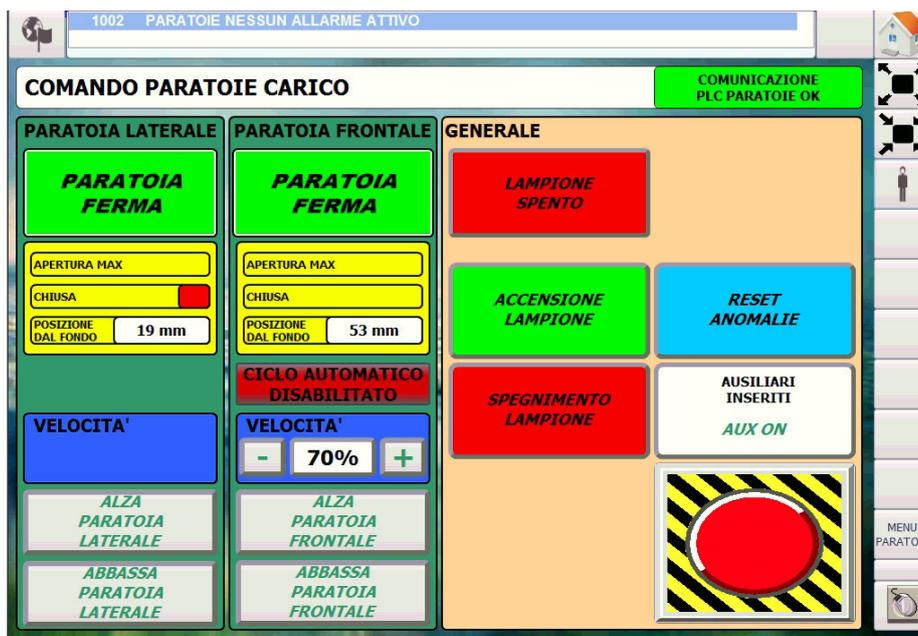
Figura 2 - Interfaccia grafica gestione paratoie – Comando paratoie carico
