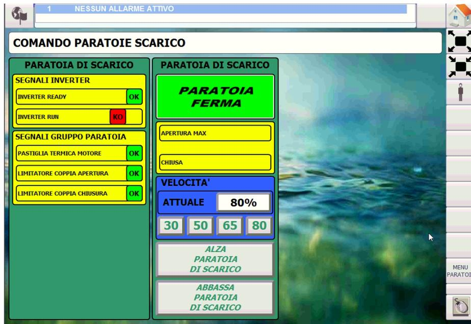
Figura 3 - Interfaccia grafica gestione paratoie – Comando paratoie scarico
