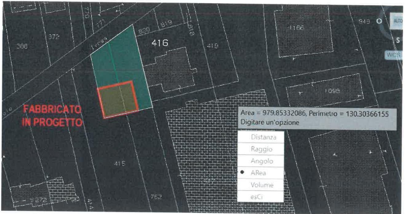
Planimetria con indicazione della struttura in progetto (rettangolo rosso), del sub ambito ipotizzato con indicazione della relativa superficie (Sul).
